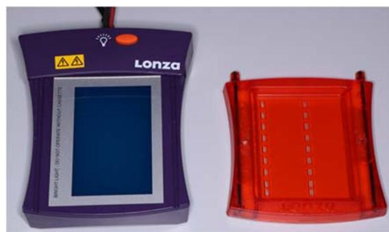
Abbildung 6: Elektrophorese- und Durchleuchtungseinheit des FlashGel™ Systems der Firma Lonza (Quelle: *teutolab-biotechnologie*)
