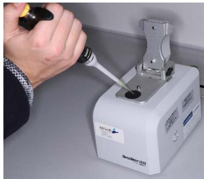
Abbildung 3: Auftragung einer DNA-Probe auf den NanoDrop (Quelle: *teutolab*-biotechnologie)
