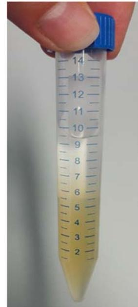
Abbildung 6: Ausfällung der DNA mithilfe von Alkohol (Quelle: *teutolab- biotechnologie*)
