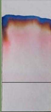
Die verschiedenen Farbbestandteile der Farbe eines schwarzen Filzstiftes haften unterschiedlich stark am Filterpapier. Wenn das Wasser am Filterpapier „hochwandert“, werden die unterschiedlichen Teilchen (Farbbestandteile) deswegen unterschiedlich schnell mitgetragen. Farb-Teilchen, die nur sehr schwach am Filterpapier haften werden vom Wasser sehr viel schneller und weiter mitgetragen als solche Teilchen, die sehr stark am Filterpapier haften.
